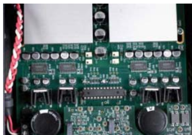
Podwójne przetworniki na każdy kanał w konwencji symetrycznej, ekranowane moduły konwersji I/U.
