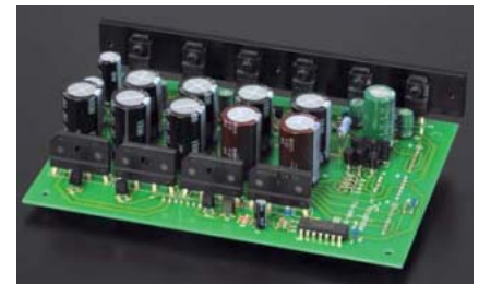
Konstrukcja zasilacza DP-700 opiera się na wielu niezależnych uzwojeniach wtórnych, za każdym pracuje prostownik i bateria stabilizatorów.
